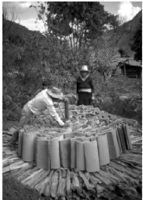
Figura 46. El fogon para quemar las tejas consume bastante leña. La madera es puesto en un circulo y encima las tejas para la quema. // The open fire place used for burning of the tiles consume a lot of firewood. The wood is placed in a circle with the tiles on top.
